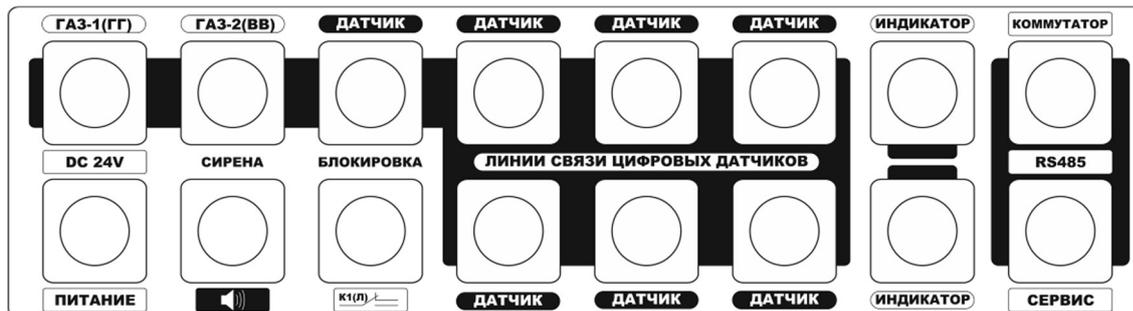
Рисунок 26. Пример подписи разъемов модуля управления (модуля коммутации)
