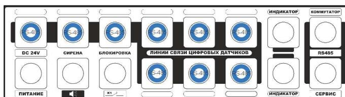
Рисунок 5. Типовые места подключения цифровых датчиков
