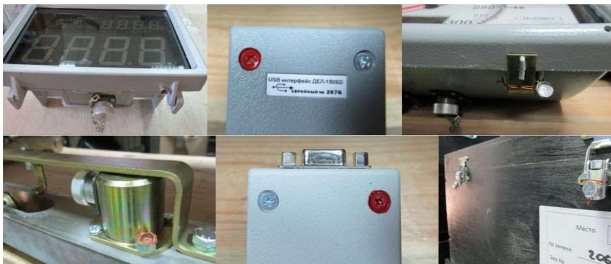
Рисунок 21. Примеры пломбирования
