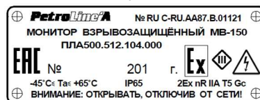
Рисунок 8. Пример маркировки МВ-150
