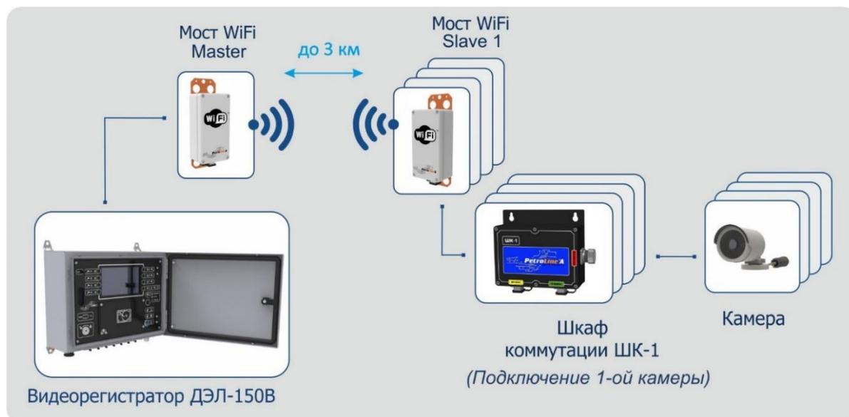
Рисунок 25. Пример №2 обобщенной блок-схемы подключения ДЭЛ-150ВЗ
