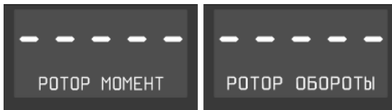
Рисунок 18. Показания в окне параметра модуля индикации при потере связи с индикатором
